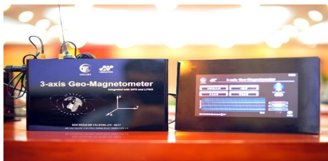
Hình 1. Hệ thống thiết bị đo từ trường trái đất tích hợp kỹ thuật GPS và truyền phát không dây độ phân giải từ trường 0,1 nanoTesla và phân giải góc 0,01 độ
